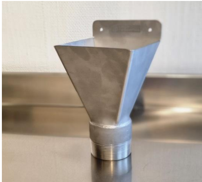
Betad, matt yta och utvändigt gängad anslutning. Hål Ø5 mm, 2 st för infästning. Silikonfri.
